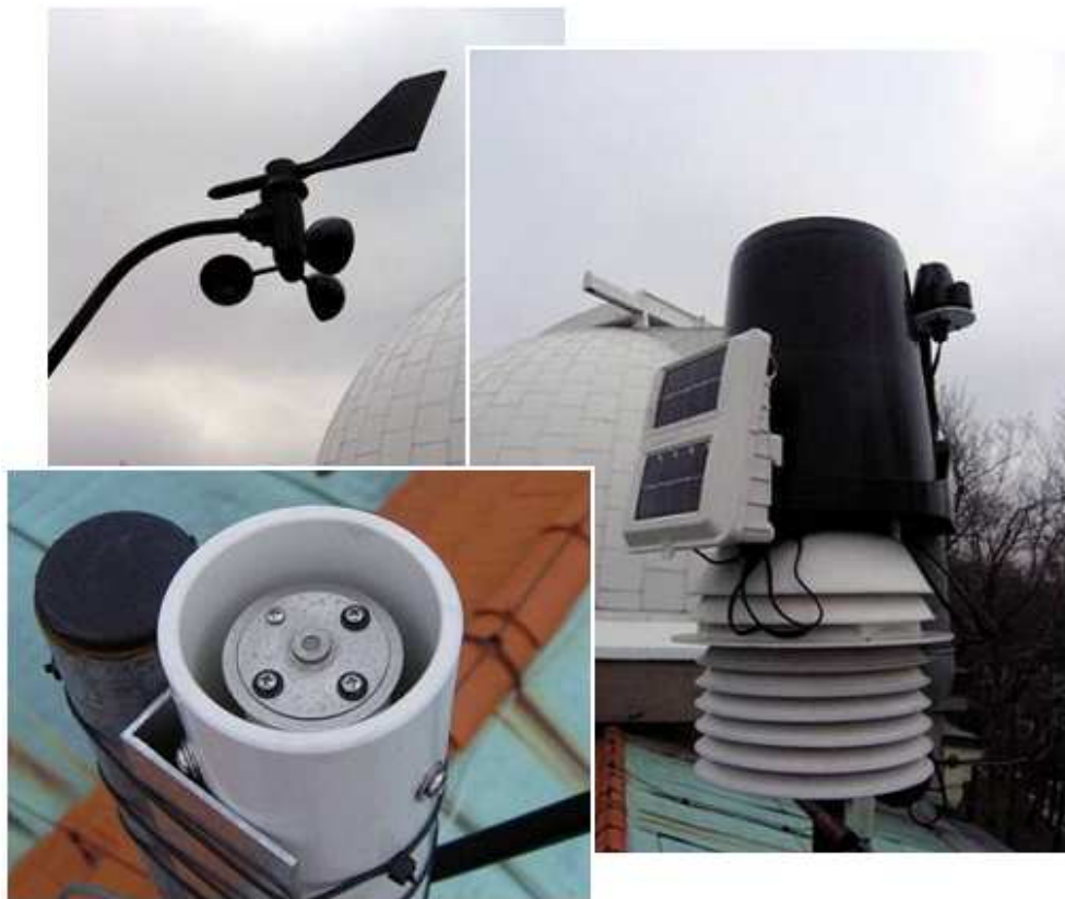
Obr. 4 Čidla pro analýzu počasí - meteostanice Davis Vantage Pro2 a dole vlevo senzor oblačnosti a srážek Boltwood Cloud Sensor 11
